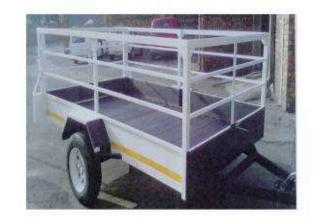
3M X 1.5M X 900MM SINGLE AXLE TRAILER WITHOUT BRAKES 1 X 750KG UN-BRAKE AXLE 13ââ,¬ • RIMS AND TYRES SPARE WHEEL EXCLUDING **INCLUDING REGISTRATION PAPERS** SABS REGISTERED **DELIVERY EXCLUDING** CALL ON 076 021 0916 R13
